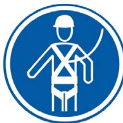
Protección individual obligatoria contra caídas
